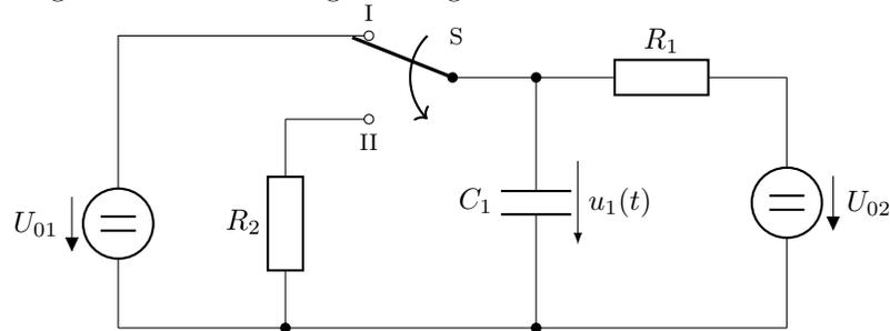
Zum Zeitpunkt  $t = 0$  wird der Schalter S in Stellung II gebracht:
