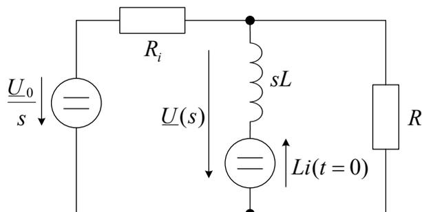
b) Die LAPLACE-Transformierte  $\underline{U}(s)$  der Spannung  $u(t)$  für  $t \geq 0$ ?
