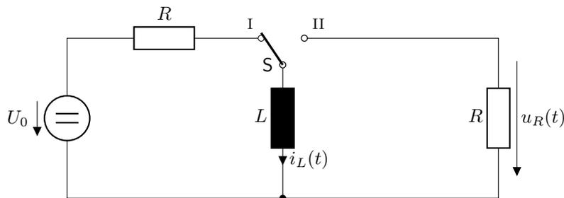
Zum Zeitpunkt  $t = 0$  wird der Schalter S in Stellung II gebracht:
