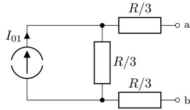
Gesucht sind Größen der Ersatzstrom- und Ersatzspannungsquelle ( $R_i$ ,  $I_K$ ,  $U_L$ ) für das Netzwerk bezüglich der Klemmen a und b, sowohl als Funktion von  $I_{01}$  und  $R$ , als auch zahlenmäßig.
