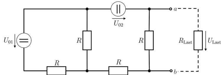
Gesucht sind die Größen der Ersatzstrom- und Ersatzspannungsquelle ( $R_i$ ,  $I_K$ ,  $U_L$ ) für das Netzwerk bezüglich der Klemmen  $a$  und  $b$  als Funktion von  $U_{01}$ ,  $U_{02}$  und  $R$ :
