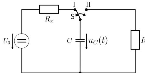
Zum Zeitpunkt  $t = 0$  wird der Schalter  $S$  in Stellung II gebracht:
