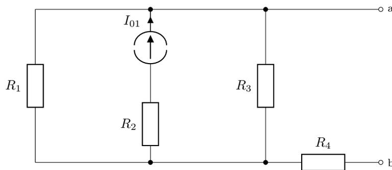
Gesucht sind die Größen der Ersatzstrom- und Ersatzspannungsquelle ( $R_i, I_K, U_L$ ) für das Netzwerk bezüglich der Klemmen a und b als Funktion von  $I_{01}, R_1, R_2, R_3$  und  $R_4$ .
