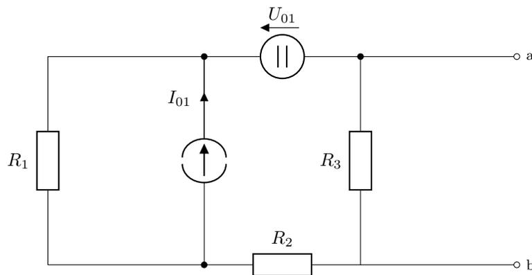
Gesucht sind die Größen der Ersatzstrom- und Ersatzspannungsquelle ( $R_i$ ,  $I_K$ ,  $U_L$ ) für das Netzwerk bezüglich der Klemmen a und b als Funktion von  $I_{01}$ ,  $U_{01}$ ,  $R_1$ ,  $R_2$  und  $R_3$ .
