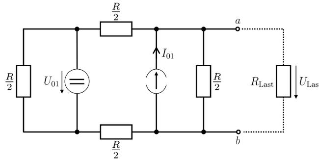
Gesucht sind die Größen der Ersatzstrom- und Ersatzspannungsquelle ( $R_i$ ,  $I_K$ ,  $U_L$ ) für das Netzwerk bezüglich der Klemmen  $a$  und  $b$  als Funktion von  $U_{01}$ ,  $I_{01}$  und  $R$ :
