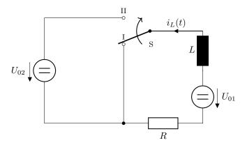
Zum Zeitpunkt t = 0 wird der Schalter S in Stellung II gebracht:
