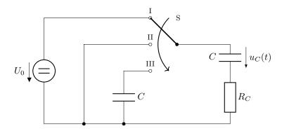
Zum Zeitpunkt t = 0 wird der Schalter S in Stellung II gebracht:
